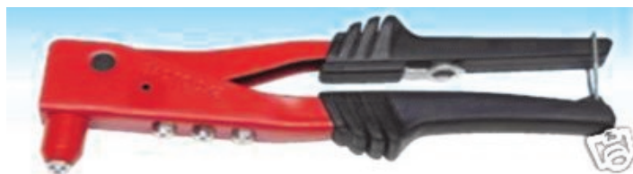
RIVDX2 Rivettatrice manuale per rivetti in alluminio da \varnothing 2,4 \div 4,8 mm - fino a \varnothing 4 mm acciaio, rame, inox.
